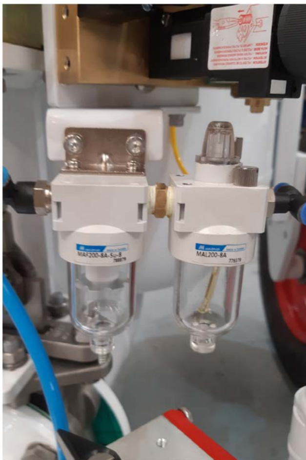
Рисунок 6 – Воздушный фильтр и лубрикатор (кожух снят)
