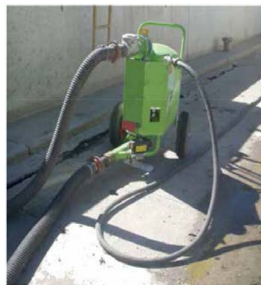
Рисунок 4 – SV60V с подключенными всасывающим, напорным и воздушным шлангами
