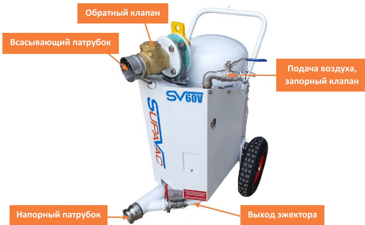
Рисунок 1 – Основные составляющие части SV60V
