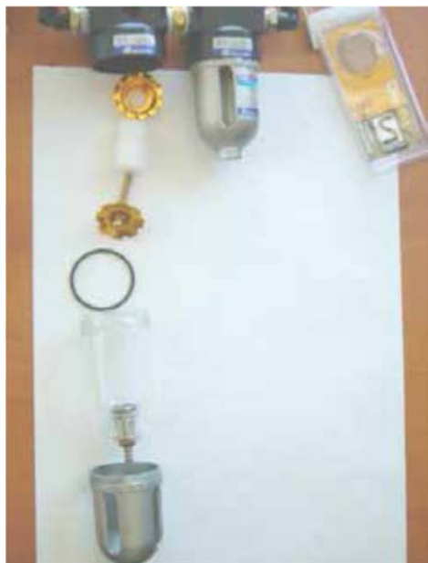
Рисунок 7 – Воздушный фильтр в разобранном виде
