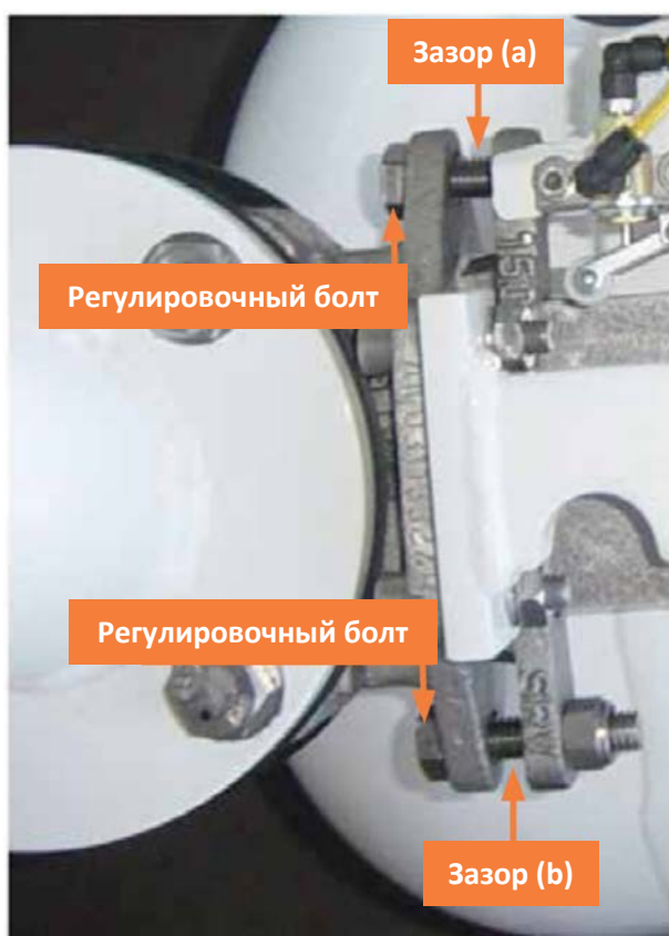
Рисунок 10 – Регулировочные болты уплотнений
