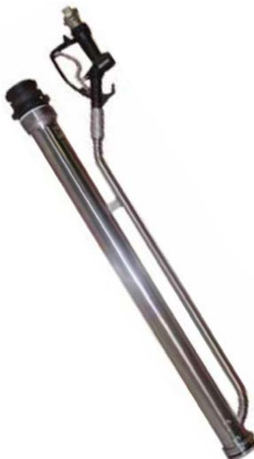
Наконечник Air Assist был разработан для того, чтобы ускорить сбор и движение перекачиваемой среды в линии. Воздух подается в насадку через кольцевой эжектор и сопло Air Assist, которое, создавая свой собственный вакуум, ускоряет среду и аэрирует ее.
