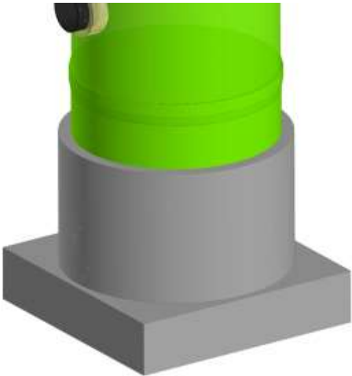
Рисунок 3 – пример устройства бетонного пригруза корпуса
