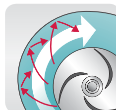
Стандартное рабочее колесо не предполагает однородность потока.
