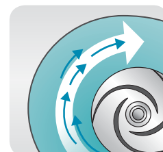
Рабочее колесо Flygt сохраняет однородность потока, удерживая твердые частицы внутри жидкости.
