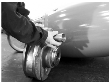
с) Снимите компенсационную крышку.
