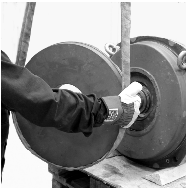
с) Снимите компенсационную крышку.
