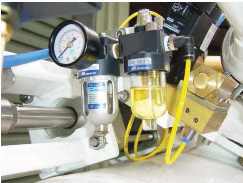
Рисунок 6 – Воздушный фильтр и лубрикатор (кожух снят). Изображенный манометр на текущий момент устанавливается возле главного запорного клапана.
