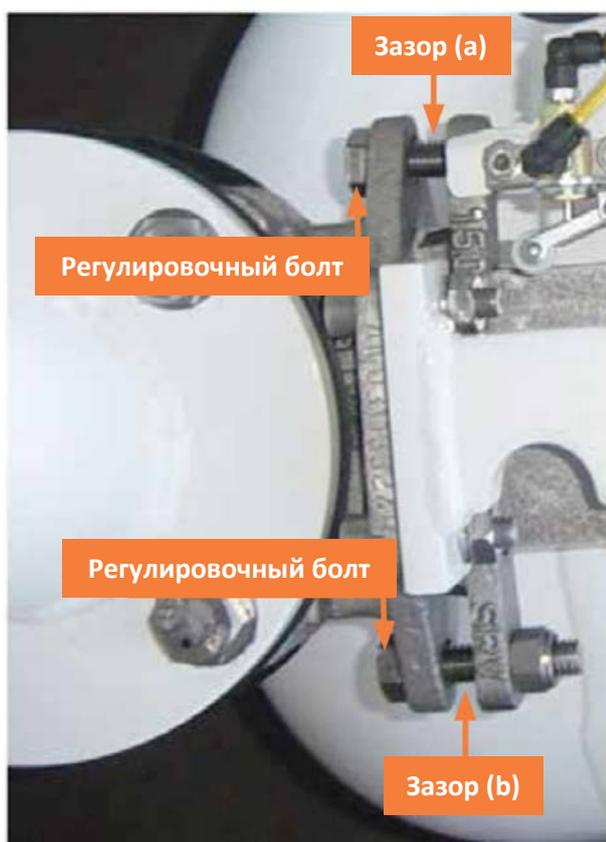
Рисунок 10 – Регулировочные болты уплотнений
