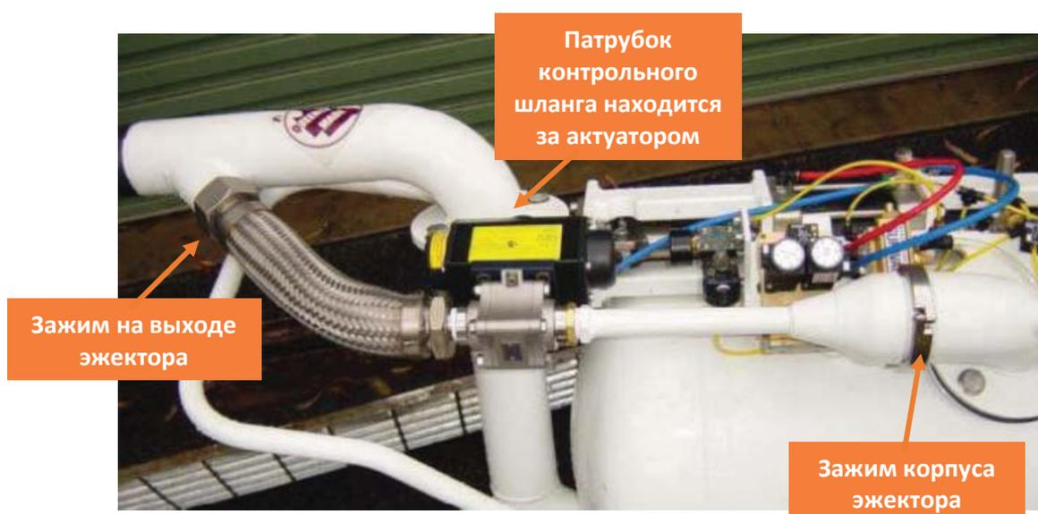
Рисунок 9 – Корпус эжектора
