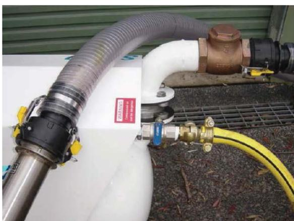
Рисунок 3 – SV60 с подключенными всасывающим, напорным и воздушным шлангами
