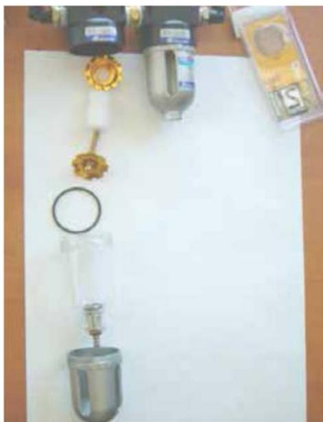
Рисунок 7 – Воздушный фильтр в разобранном виде
