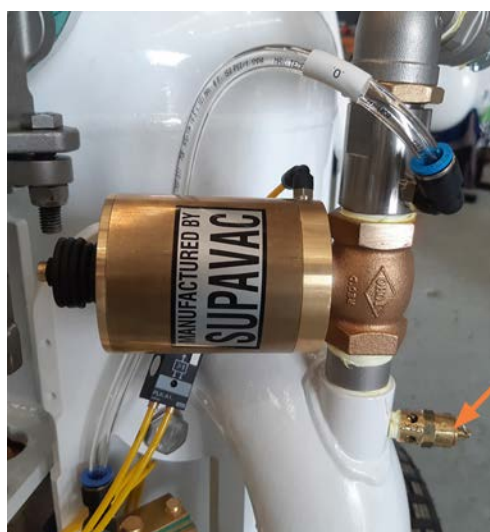
Рисунок 8 – Предохранительный клапан (кожух снят)
