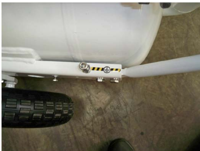
Рисунок 2 – Контактная площадка заземления на S110V
